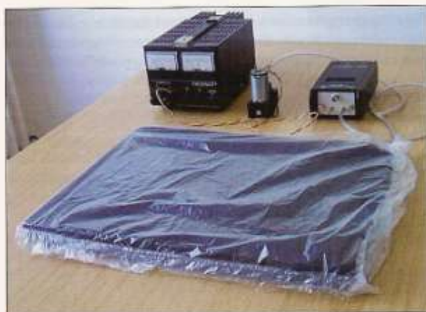
Bild 1 Dämmelement ohne Differenzdruck.
